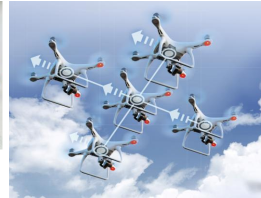
Ein Multiagentensystem, bestehend aus fünf Drohnen, im Formationsflug.
