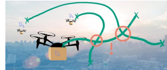
Drei Drohnen D_{1,2,3} in einem urbanen Flugszenario. In grün sind die Trajektorien mit den Start- und Endpunkten dargestellt. Es ergeben sich die in rot markierten potentiellen Kollisionspunkte auf den Trajektorien. Dort ist ein Ausweichmanöver notwendig
