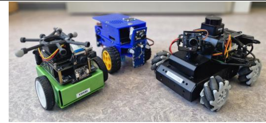
Heterogene mobile Roboter vom Typ JetBot, DuckieBot und MentorPi
