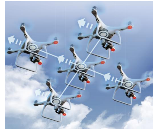
Ein Multiagentensystem, bestehend aus 5 Drohnen, im Formationsflug. Die N_A = 4 äußeren Drohnen geben die Formation vor (Formation Control) und die N_I = 1 mittlere Drohne platziert sich mittig in der Formation (Containment Control).
