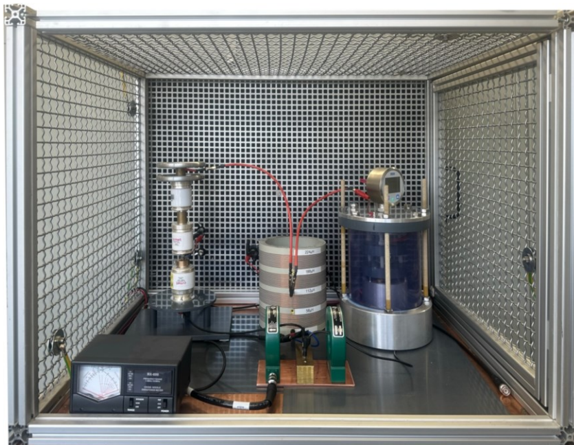
Abb.3: Einer der drei Versuchsaufbauten zur Erzeugung hochfrequenter Hochspannung und Messung der dielektrischen Kenngrößen eines festen Isolierstoffs
