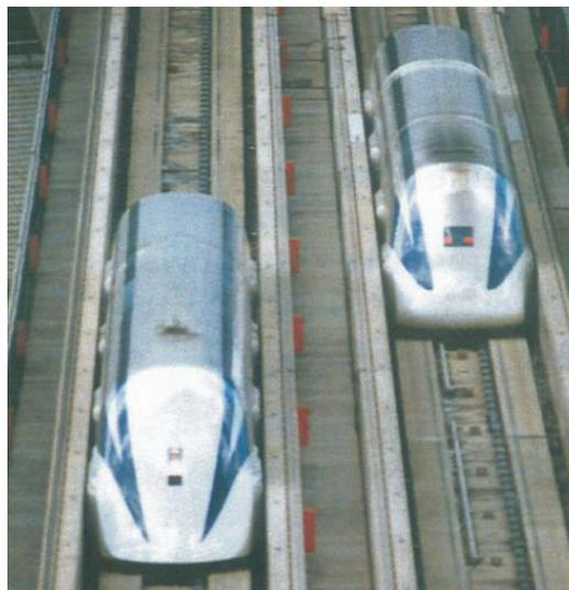
Bild 3.4.2-4: Unbemannte Versuchsfahrzeuge auf der *Yamanashi*-Teststrecke – Begegnung bei 1003 km/h Relativgeschwindigkeit auf der *Ogatayama*-Brücke[3.9]
