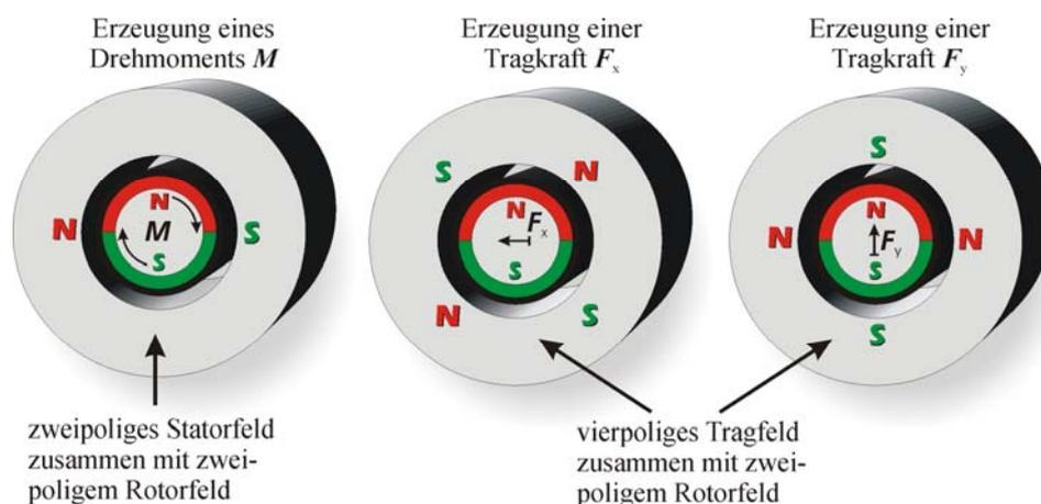
Bild 3.6.1-2: Anschauliche Erklärung der Querkräfte im lagerlosen PM-Synchron-Motor (Quelle: TU Darmstadt, T. Schneider)
