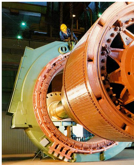
Bild 1.3-6: Synchron-Vollpol-Stromrichter-motor (Walzwerksantrieb) Siemens AG
