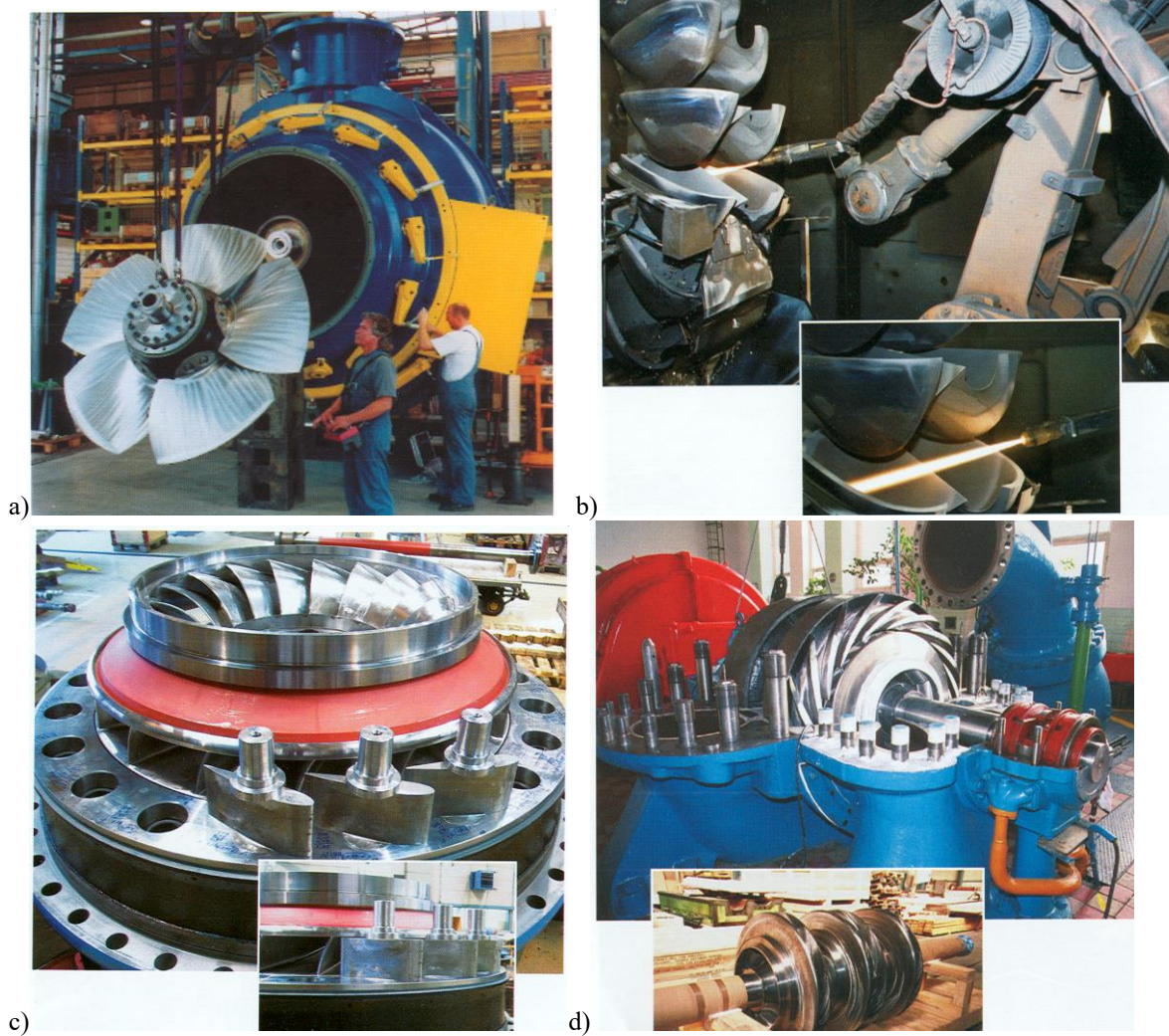
Bild 5-5: a) Kleine Kaplan-Turbine beim Einbau, b) Peltonrad: Fertigung – Flüssigmetall aufspritzen zur Oberflächenvergütung, c) Francis-Läufer, Detail: Leitschaufeln, d) 3-stufige Radialpumpe (Andritz Hydro)
