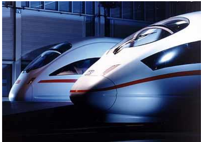
Bild 1.1-6: Hochgeschwindigkeitstriebzug ICE3, Drehstrom-Asynchron-Fahrmotoren, 16x500 kW, Deutschland, 2001, Umformung des 16.67 Hz-Fahrdrahtstroms durch Umrichter in frequenzstellbaren Drehstrom (Quelle: DB AG )
