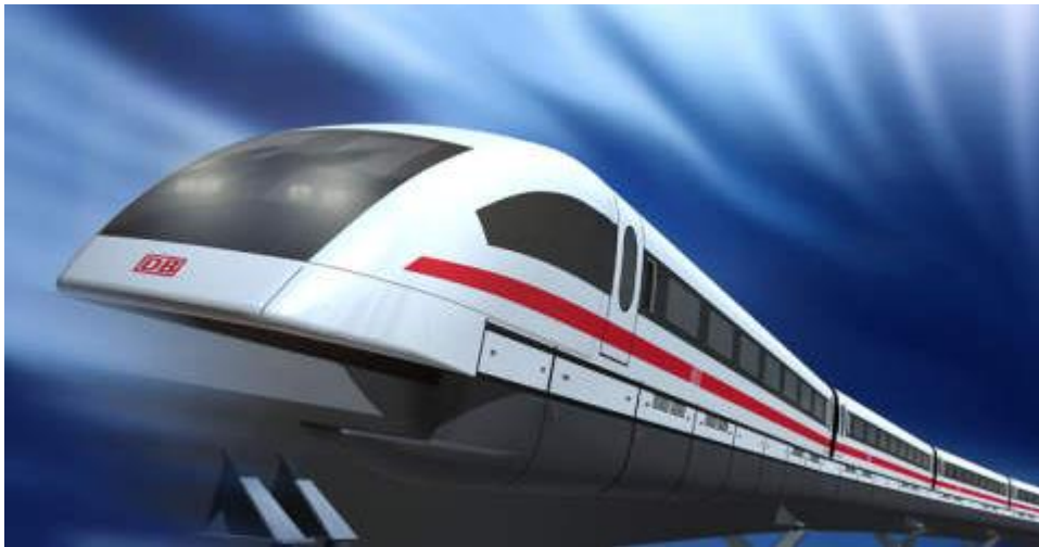
Bild 1.3-3: TRANSRAPID-Magnetschwebebahn mit Synchron-Linear-Langstatormotor und elektromagnetischem Schweben (abstandsgeregelte Elektro-Trag- und Führungsmagnete) (Quelle: Thyssen-Krupp )
