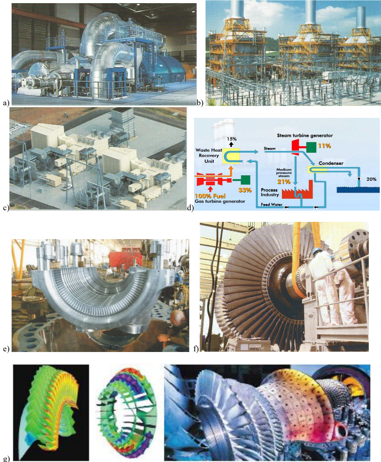
Bild 5-7: a) Braunkohle-Kraftwerk „Schwarze Pumpe“, 2 x 800 MW, b) GuD (Gas und Dampf)-Kraftwerk Tapada do Outeiro, Portugal, Einwellenanordnung, 3 x 333 MW = 1000 MW, c) Gasturbinen-Kraftwerk Cass county, Nebraska, USA, 2 x 200 MW, d) Industrie-Kraftwerk GuD mit Nutzung der Restwärme als Prozessdampf (z. B. Papiererzeugung), Zweiwellen-Anordnung, ele. Wirkungsgrad: 33 + 11 = 44%, thermischer Wirkungsgrad: 44 + 21 = 65%, e) Montages des Dampfturbinen-Hochdruckgehäuses (Dampf 276 bar, 600°C), f) Montage der doppelflutigen Niederdruck-Dampfturbinenrotoren (Dampf: 39 mbar, Rotormasse 260 Tonnen), g) Numerische Strömungsberechnung (Navier-Stokes-Gleichungen) für optimierte Schaufelprofile einer Gasturbine
