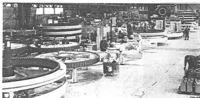
Bild 6.2.3-1: Getriebelose hochpolige Synchron­generatoren für Umrichterspeisung der Ständerwicklung für Windturbinen (Enercon)
