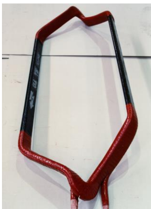
Bild 5.3.2.4-3: Isolierte Hochspannungs-Ganzformspulen (links), Niederspannungserregerspule (rechts): Einbringen der Isolationszwischenlagen (Quelle: Andritz Hydro)
