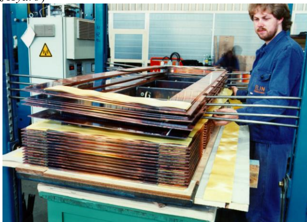
Bild 5.3.2.4-3: Isolierte Hochspannungs-Ganzformspulen (links), Niederspannungserregerspule (rechts): Einbringen der Isolationszwischenlagen (Quelle: Andritz Hydro)
