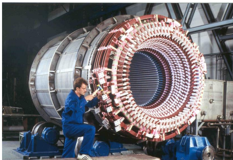
Bild 3.7-3: Montage der Anschlüsse an die ROEBEL-Stäbe im Wickelkopf eines luftgekühlten Turbogenerators (Quelle: BBC)
