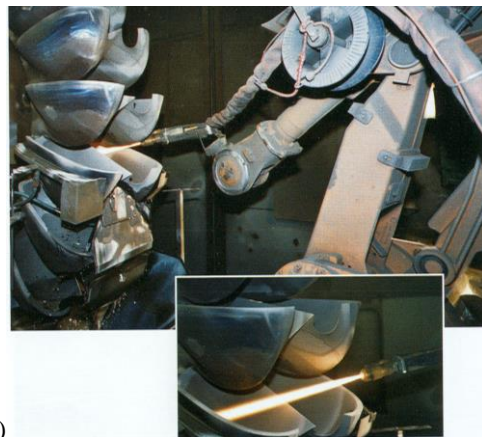
Bild P3.2.2-5: Pelton-Turbine a) Idealisiert: Drehmoment M und Leistung P in Abhängigkeit von n , Anfahr-drehmoment M_{\max} , Leerlaufdrehzahl n_{\max} . b) Schaufelfertigung: Oberflächenvergütung (Quelle: Andritz Hydro).
