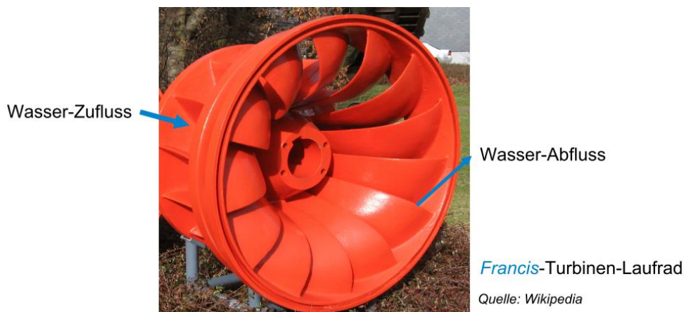
Bild P3.2.4-1: Läufer einer Francis-Turbine : Die gekrümmten Laufschaufeln sind gegossen und nicht verstellbar (Quelle: Wikipedia.de).
