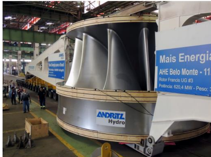
Wasserkraftwerk Belo Monte, Brasilien 18 x 611 MW = 11 GW (viertgrößtes Wasser-KW der Welt!), h = 87 m, 85.7/min, 60 Hz, Laufraddurchmesser d = 8.27 m, Fluss Rio Xingu, 84-polige Synchrongeneratoren
