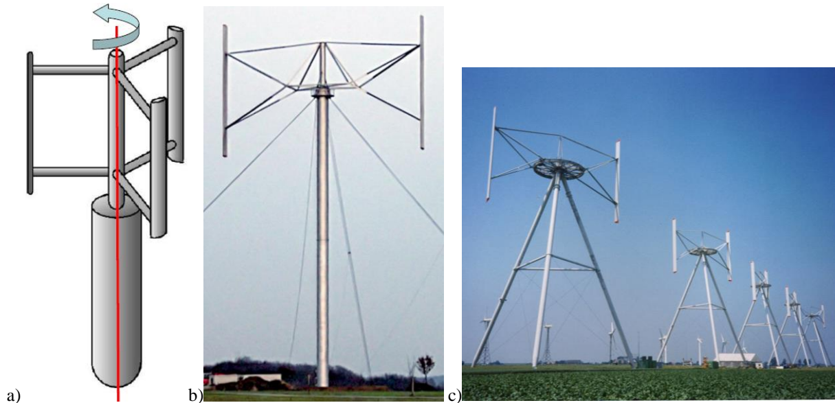
Bild P3.3.2-3: a) Prinzipanordnung eines Dreiflügel-H-Darrieus-Rotors, b) Zweiflügel-H-Darrieus-Rotor Dülmen-Rorup, D, c) Zweiflügel-H-Darrieus-Rotoren im Windenergiepark Westküste, Kaiser-Wilhelm-Koog, Schleswig-Holstein, D (Quelle: Quaschnig, Regenerative Energien & Wikipedia.de).
