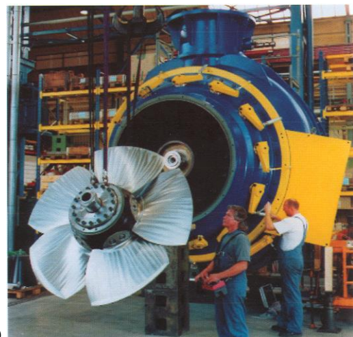
Bild P3.2.3-5: a) Kavitation an einem Schiffspropeller (Quelle: Wikipedia.de), b) Kaplan-Laufrad beim Einbau in eine Rohrturbine (Quelle: Andritz Hydro).
