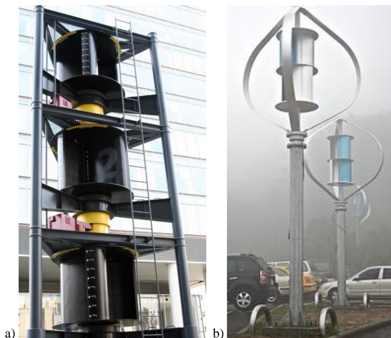
Bild P3.3.2-4: a) Drei gegenläufige, dreiflügelige Savonius -Rotoren (UDX-Hochhaus Akihabara, Tokio, Japan), b) Zwei Savonius -Rotoren nahe der Drehachse, zum Selbstanlauf des Vier-Flügel-Darrieus-Rotors (außen) (Jinguashi, New Taipei City, Taiwan) (Quelle: Wikipedia.de).
