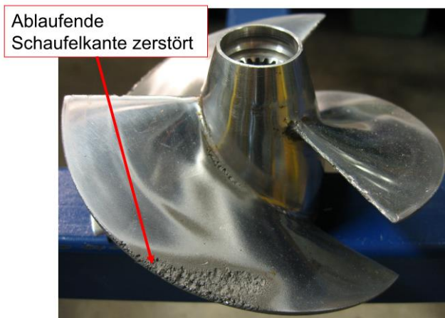
Bild P3.2.3-5: a) Kavitation an einem Schiffspropeller (Quelle: Wikipedia.de), b) Kaplan-Laufrad beim Einbau in eine Rohrturbine (Quelle: Andritz Hydro).
