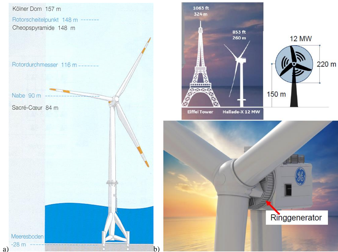
Bild P3.3.4-6: a) Off-shore-Windenergieanlage P_N = 5 \text{ MW} im Nordsee-Windpark ALPHA VENTUS für Pitch-Betrieb mit dreistufigem Getriebe und schnell drehendem Asynchrongenerator (Quelle: M. Nyfeler, A. Moglestue, ABB Technik 3/2010), b) Im Jahr 2019 größte Windturbine Haliade-X, P_N = 12 \text{ MW} , Firma GE, St. Nazaire, F, mit direkt gekuppeltem langsam drehendem ringförmigem Synchrongenerator (Quelle: GE).
