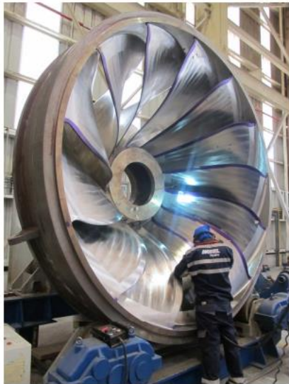
Wasserkraftwerk Temascal I, Mexiko 4 x 38.5 MW, h = 50 m, 180/min, 60 Hz, Laufraddurchmesser d = 3.6 m, 40-polige Synchrongeneratoren
