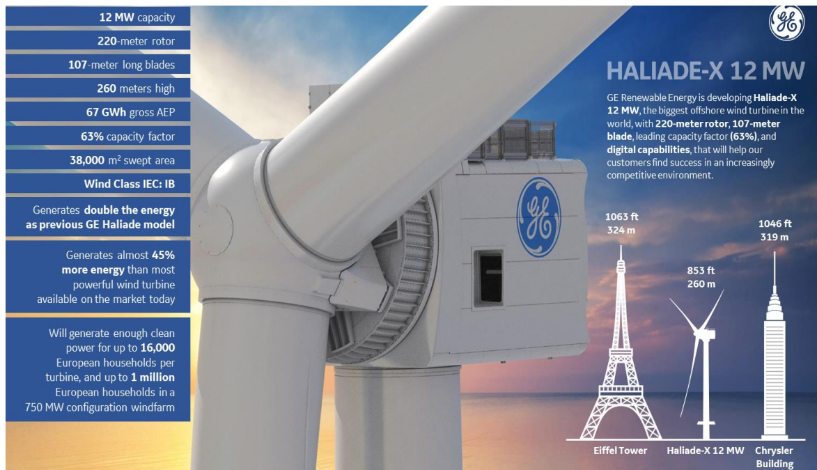
Bild R4.3-3: Getriebelose 12 MW-Windturbine mit direkt gekoppeltem Synchron-Ringgenerator Haliade-X mit Permanentmagnet-Erregung (Quelle: General Electric ).
