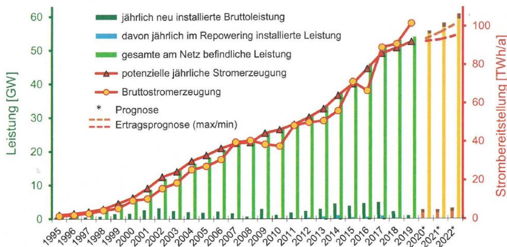
Bild R4.4-1: Installierte „Onshore“-Windenergie-Anlagen und ihr jährlicher Zubau in Deutschland sowie daraus bereitgestellte el. Energie („Strombereitstellung“) (Quelle: BWK 72/ 2020 , no. 8-9).
