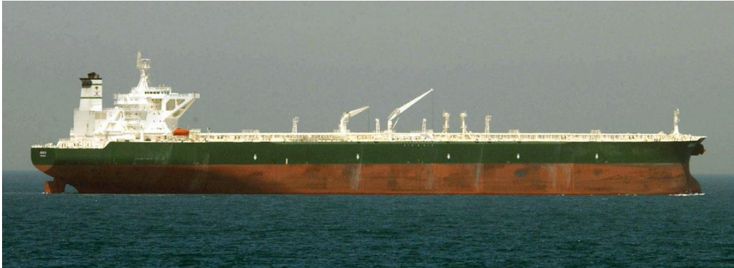
Bild R13.1-1: Kommerzieller Supertanker AbQaiq , gebaut 2002 für den Transport von 2 Mio. barrels Rohöl je Schiffsladung (Quelle: U.S. Navy photo, K. H. Tierney ).
