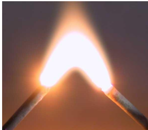
Stationär brennender Lichtbogen zwischen zwei Stahlnägeln
