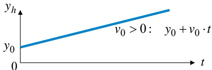
$$(T \cdot \ddot{y} + 0 \cdot \dot{y} + 0 \cdot y = T \cdot \ddot{y} = 0 \quad \ddot{y} = 0 \quad y_h(t) = v_0 t + y_0)$$
