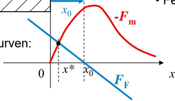
$$m \cdot \ddot{x} = F_F + F_m \Rightarrow m \cdot \ddot{x} - F_F(x) - F_m(x) = 0, \quad m \cdot \ddot{x} + k \cdot (x - x_0) - \frac{I^2}{2} \cdot \frac{dL(x)}{dx} = 0$$
