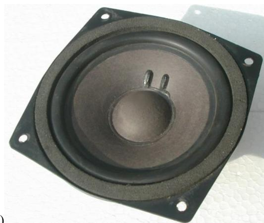
Bild 7.2-2: a) Elektro-dynamischer Lautsprecher (Tauchspulenprinzip) mit „Lautsprecherkorb“ bei entfernter „Abdeckkappe“, Papier-Konusmembran und Gummi-Sicke als Feder, b) „Abdeckkappe“ (Staubschutzkalotte) (Quelle: [Wikipedia.de](http://Wikipedia.de)).
