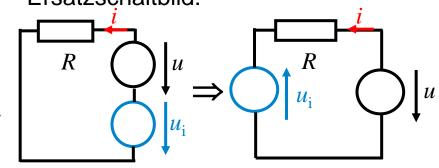
R: Schleifen-Widerstand u: Klemmenspannung  $u_i$ : induzierte Spannung  $u_q = -u_i$ : Quellen-Spannung
