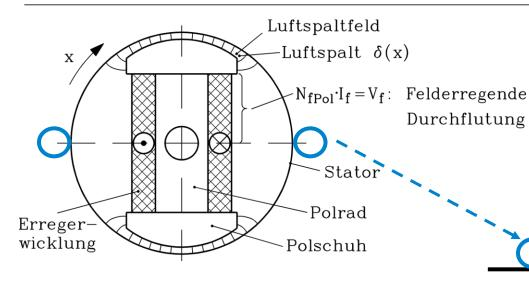
2p-poliges Polrad dreht mit der Drehzahl n (Umfangs-Geschwindigkeit v)
