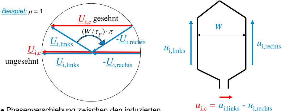
• Phasenverschiebung zwischen den induzierten Spannungen der linken und rechten Spulenseite:
