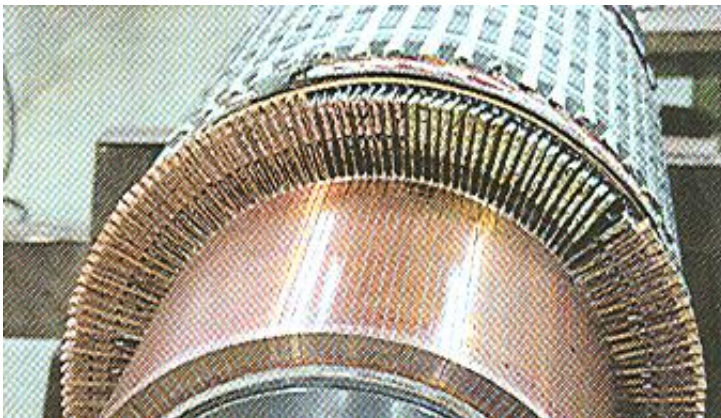
Ankerspule (Läuferspule): Unten: ungeformt Oben: geformt
