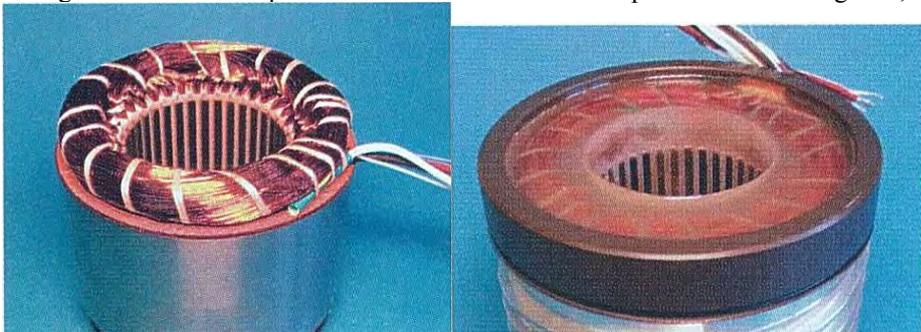
Formen und Bandagieren der Wickelköpfe      Hochwertiger Harzverguss im Vakuum des kompletten Stators
