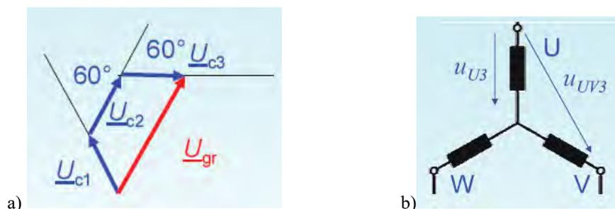
Bild 4.3-4: a) Wie Bild 4.3-2, jedoch für  $\mu = 3$ . Es ist daher  $\alpha_Q = \mu \pi \tau_Q / \tau_p = 3 \cdot 20^\circ = 60^\circ$  und  $k_{d3} = 0.667$ .
