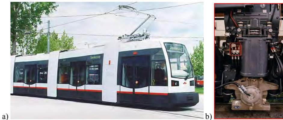
Bild 7.5-3: a) Elektrische Niederflur-Straßenbahn, b) seitlich vertikal eingebaute umrichtergespeiste 80 kW-Käfigläufer-Fahrmotoren treiben über 90°-Kegelradgetriebe die einzelnen Räder, so dass 100% Niederflurbauweise dazwischen möglich ist (Quelle: *Wiener Linien* und *ELIN-EBG Motoren GmbH, Österreich*)
