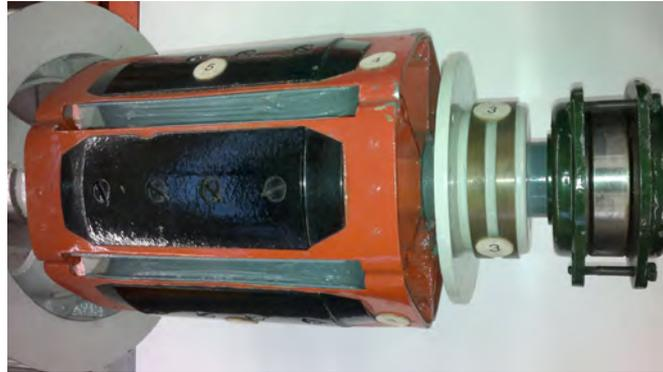
Bild 9.1-5: Sechspoliger Läufer eines Schenkelpol-Synchronmotors: links: Runddrahtspulen um die Pole (5) als Polradwicklung mit einer Kurzschlusswindung pro Pol (4) als Dämpferwicklung, rechts: Plus- und Minus-Schleifring (3) und schleifringseitiges Wälzlager (Quelle: Fa. Dornhoff)
