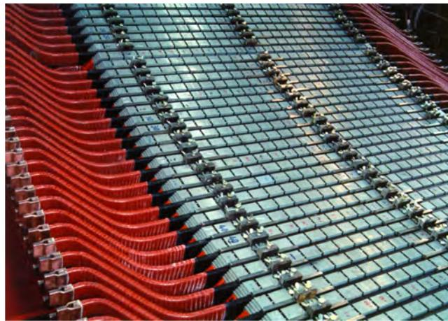
Bild 2.4-7: Einwindige Zweischichtwicklung in einem Synchron-Wasserkraftgenerator: Die einwindigen Spulen  $N_c = 1$  erlauben eine Wellenwicklung (vgl. Bild 2.4-3), dadurch weniger Stirnverbinder = Kupferersparnis. In die Nuten eingelegt als Halbspulen („Stäbe“), die zwischen Ober- und Unterschicht im Stirnbereich verlötet werden (Quelle: *Andritz Hydro/Österreich*)
