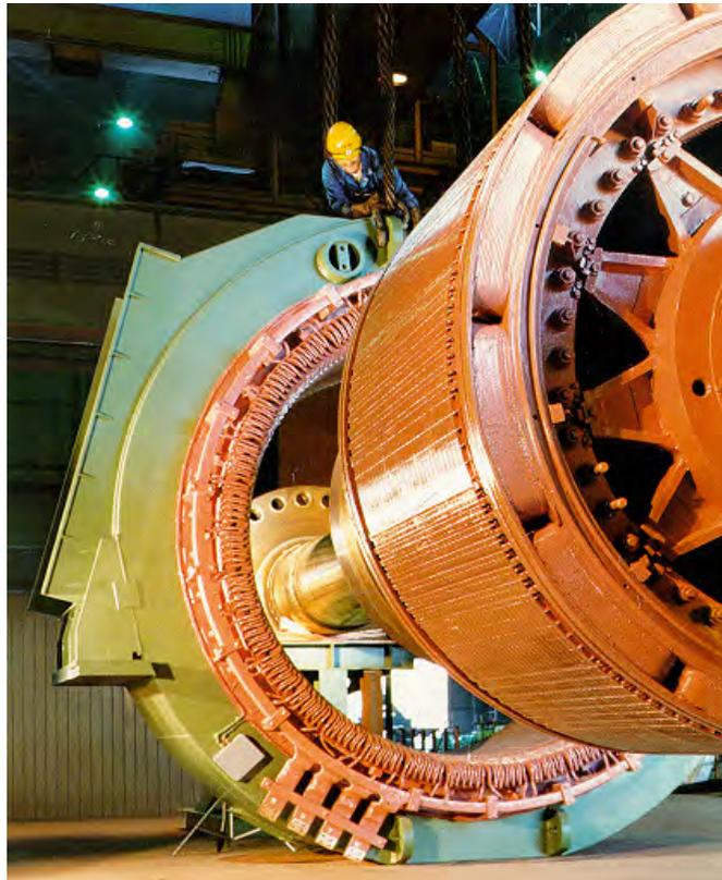
Bild 9.2-4: Drehzahlveränderbarer Synchron-Vollpolmotor für Umrichterbetrieb am 5.5m-Grobblech-Walzgerüst des Walzwerks *Dillinger Hüttenwerke AG*, 12-polig, elektrisch erregt, Nennmoment 1.78 MNm im Drehzahlbereich 0 ... 58.5/min, Nennleistung 10.9 MW im Drehzahlbereich 58.5 ... 112.5/min. Betrieb am Umrichter mit  $\cos\varphi = 1$ , ca. 2.5-fach überlastbar kurzzeitig mit dem max. Drehmoment 4.3 MNm und der max. Leistung 26.5 MW (Quelle: *Siemens AG*)
