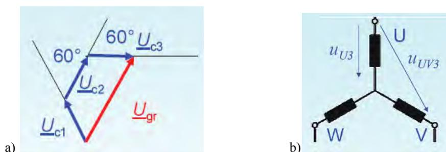
Bild 4.3-4: a) Wie Bild 4.3-2, jedoch für  $\mu = 3$ . Es ist daher  $\alpha_Q = \mu \pi \tau_Q / \tau_p = 3 \cdot 20^\circ = 60^\circ$  und  $k_{d3} = 0.667$ .
