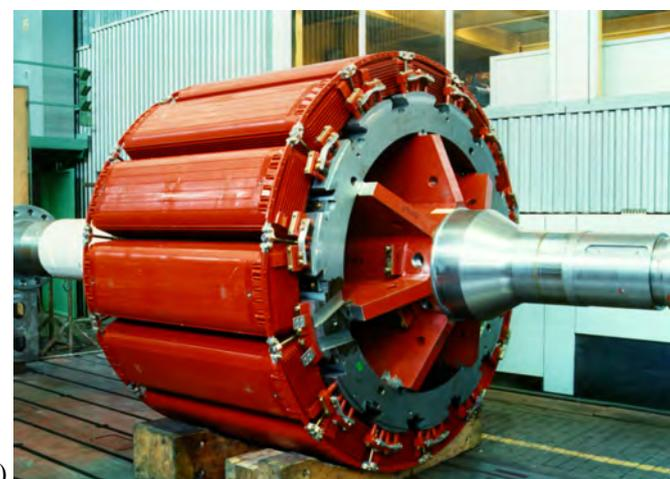
**Bild 3.3-3:** Ansichten der Läuferpole des Polrads von Schenkelpol-Synchronmaschinen: a) Mit Axiallüfter vor und hinter den Polen (Quelle: *Lloyd Dynamowerk, Bremen*), b) 14-poliger Läufer mit Schwalbenschwanzbefestigung der Pole (Quelle: *Andritz Hydro, Weiz, Österreich*)
