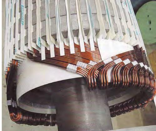
**Bild 10.5-3:** Einlegen der Zweischicht-Ankerspulen in keillose Nuten: Die Ankernuten sind ohne Keile, und die Ankerwicklung wird nur mit Glasfaserbandagen in „Umfangsnuten“ im Blechpaket bandagiert und fixiert. Der Vorteil ist eine geringere Nuthöhe, also eine geringere Ankerstreuinduktivität und damit eine geringere Reaktanzspannung (vierpolige Ankerwicklung,  $u = 3$  Spulenseiten je Nut und Schicht,  $N_c = 2$  Windungen je Spule, Quelle: Fa. Brenner, Bürstadt)
