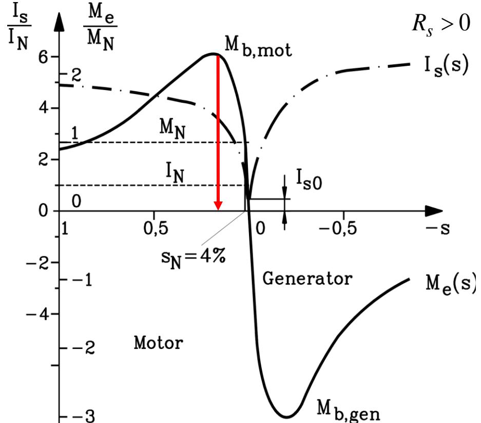
$$\frac{P_b}{S_N} \approx \frac{1-\sigma}{2\sigma \cdot x_s} \sim \frac{1}{\sigma} \cdot \frac{1}{x_s} \sim \frac{1}{\sigma} \cdot \frac{\hat{B}_{\delta 1}}{A_s} \cdot \frac{\delta}{\tau_p}$$
