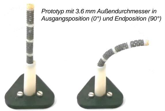
Prototyp mit 3.6 mm Außendurchmesser in Ausgangsposition (0°) und Endposition (90°)
