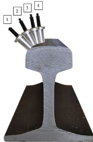
DB Systemtechnik (2014). Maschinelle Schienenbearbeitung nur noch mit integrierter Wirbelstromprüfung!
