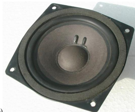
**Bild 7.2-2:** a) Elektro-dynamischer Lautsprecher (Tauchspulenprinzip) mit „Lautsprecherkorb“ bei entfernter „Abdeckkappe“, Papier-Konusmembran und Gummi-Sicke als Feder, b) „Abdeckkappe“ (Staubschutzkalotte) (Quelle: [Wikipedia.de](http://Wikipedia.de)).
