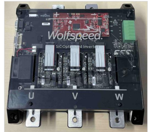
Foto des dreiphasigen Umrichter- Evaluationsboard: Wolf speed CRD300DA12E-XM3
