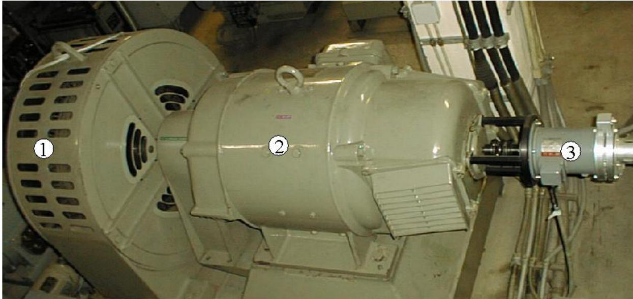
① Mittelfrequenzgenerator (MFG) ② Gleichstrommotor (GM) ③ Tachogenerator (TG)
