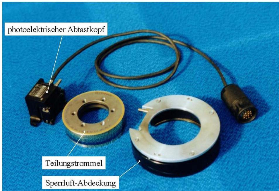
Bild A.2: HEIDENHAIN-Drehgeber ERA 180 mit einer Strichzahl von 1024
