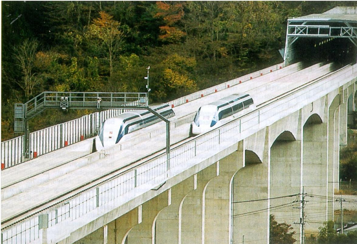
**Bild 1.6:** Fahrzeugbegegnung bei einer Differenzgeschwindigkeit von  $\Delta v = 1000 \text{ km/h}$  auf der YAMANASHI Teststrecke in Japan [Shi02].
