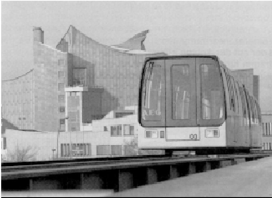
**Bild 1.4: MAGNETBAHN Berlin im Testbetrieb für einen Synchronlinearmotorantrieb in Langstatorbauweise [Hei84].**
