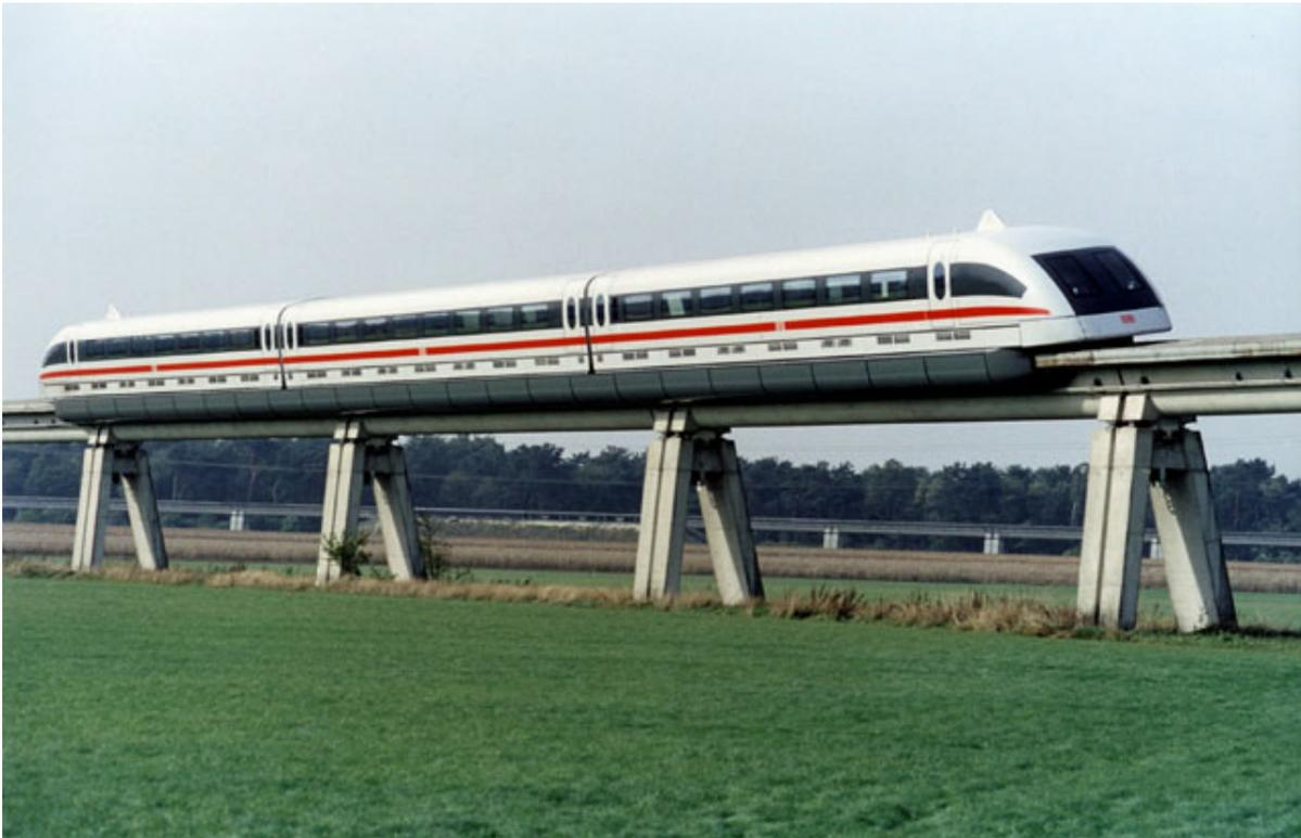
**Bild 1.5: TRANSRAPID 08 bestehend aus Mittelwagen und zwei Endwagen auf der Versuchsstrecke im Emsland [TR02].**
