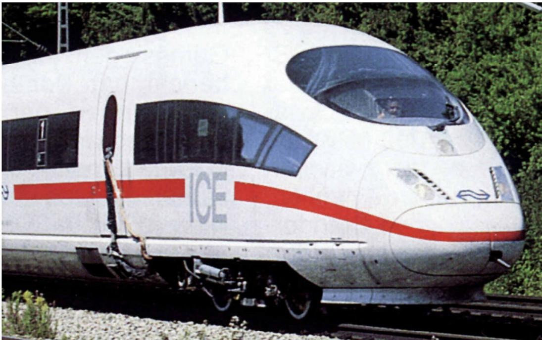
**Bild 1.1: ICE 3 mit über den ganzen Zug verteilten angetriebenen Radsätzen [B1].**
