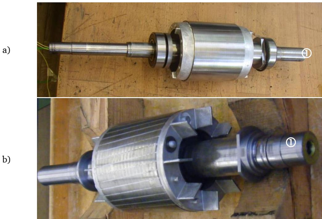
Abbildung 3-9: a) Rotor eines 1,5 kW-Asynchronmotors mit montierter Abziehhilfe ① und montierten Lagern, b) Rotor eines 11 kW-Asynchronmotors mit modifiziertem Lagersitz und eingebauter Abziehhilfe ①, ohne Lager
